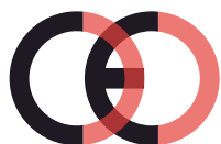
Falsk CE-mærke (for tæt på hinanden)
